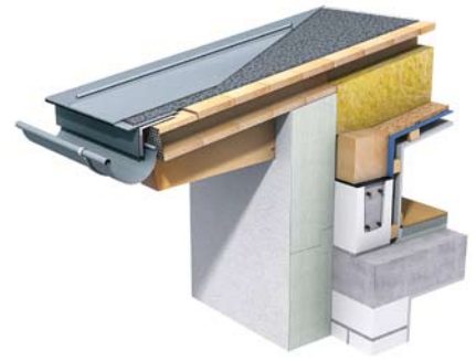
Stratificazione ventilata con coibentazione tra i puntoni
