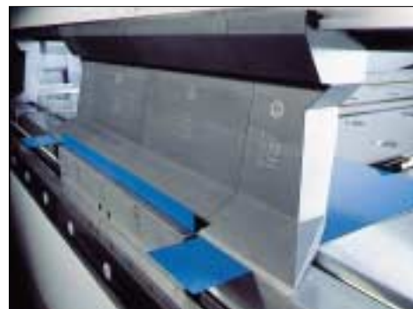
Utensili segmentati della bandiera di piega, ad es. per linee di piegatura sfalsate.
