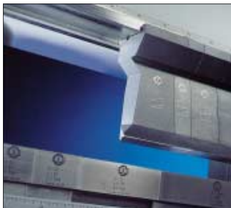
Serraggio automatico degli utensili nella ganascia superiore.
