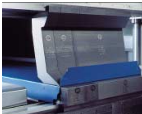
Utensili segmentati della ganascia inferiore per pieghe negative fino a 40 mm.
